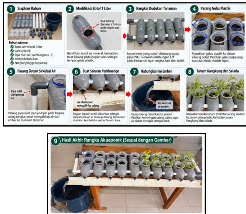
Gambar 3. Tahapan perakitanudukan tanaman, pemasangan wadah tanaman, dan penyusunan sistem sirkulasi akuaponik sederhana.
