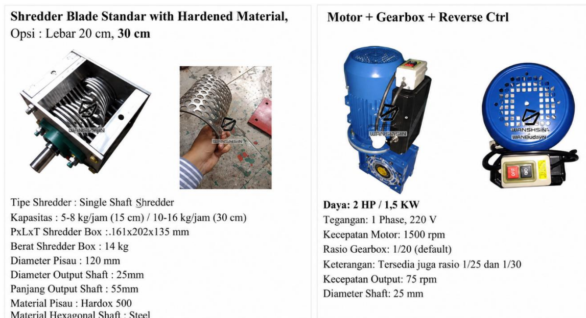
Gambar 3. Komponen utama mesin pencacah ikan sapu-sapu
