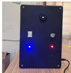
Gambar 6. Pengujian Buzzer dan Lampu LED Merah.
