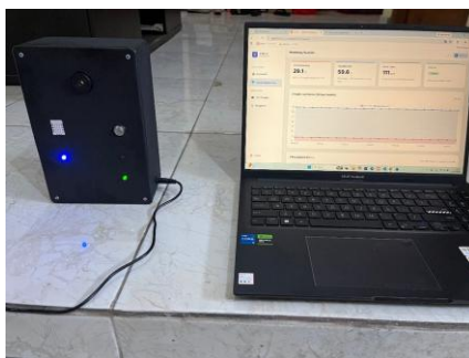
Gambar 2. Pengujian Sensor DHT22 ketika kondisi lingkungan aman.
