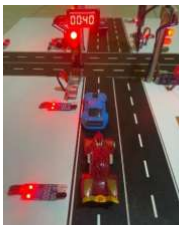
Gambar 5. Pengujian Sensor Inframerah.
