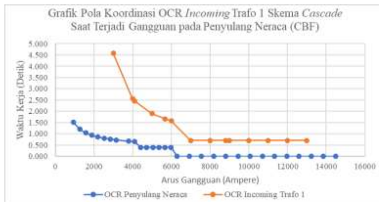
Gambar 9. Grafik Perbandingan Waktu Kerja Dengan Arus Gangguan Pola Koordinasi OCR Incoming Trafo 1 Skema Cascade Saat Terjadi Gangguan Pada Penyulang Neraca Dan Penyulang Neraca Gagal Trip (CBF).
