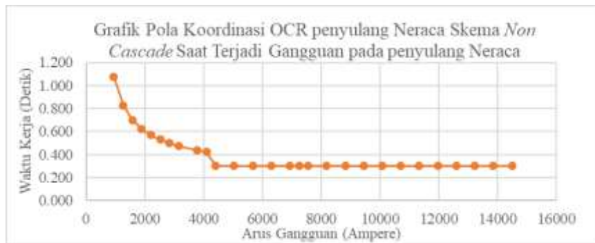
Gambar 5. Grafik Perbandingan Waktu Kerja Dengan Arus Gangguan Pola Koordinasi OCR Penyulang Neraca Skema Non Cascade Saat Terjadi Gangguan Pada Penyulang Neraca.
