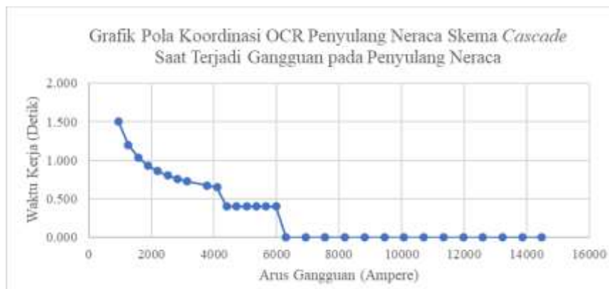
Gambar 6. Grafik Perbandingan Waktu Kerja Dengan Arus Gangguan Pola Koordinasi OCR Penyulang Neraca Skema Cascade Saat Terjadi Gangguan Pada Penyulang Neraca.
