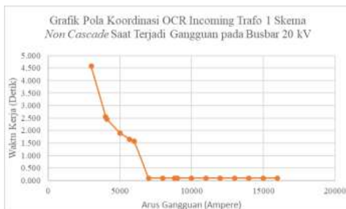
Gambar 11. Grafik Perbandingan Waktu Kerja Dengan Arus Gangguan Pola Koordinasi OCR Incoming Transformer 1 Skema Non Cascade Saat Terjadi Gangguan Pada Busbar 20 Kv.
