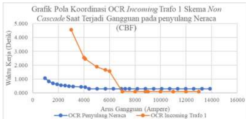
Gambar 8. Grafik Perbandingan Waktu Kerja Dengan Arus Gangguan Pola Koordinasi OCR Incoming Trafo 1 Skema Non Cascade Saat Terjadi Gangguan Pada Penyulang Neraca Dan Penyulang Neraca Gagal Trip (CBF).
